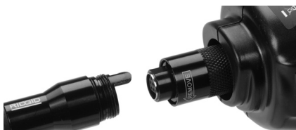
Figure 8 – Connexion du câble
