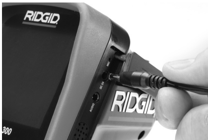
Figura 7 – Alimentación eléctrica del aparato
